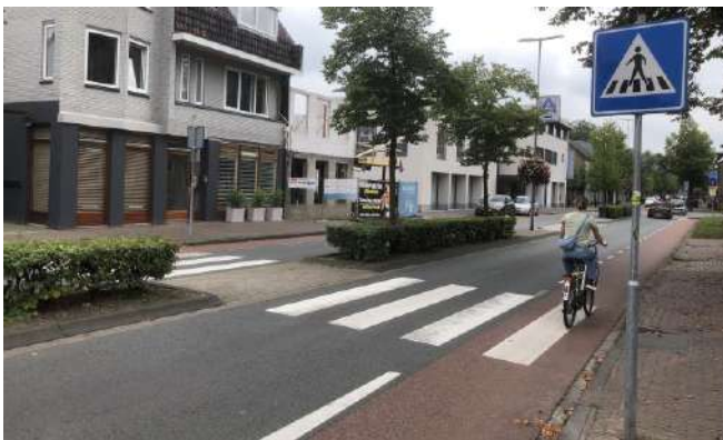
Dit zebrapad voldoet niet aan de basisnorm / geen verkeersremmende maatregelen > 30 km/h
